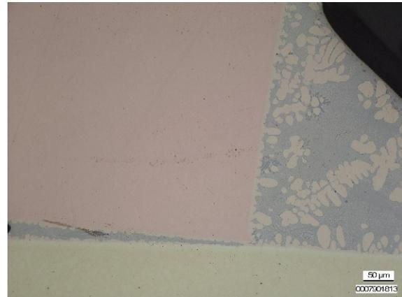
Bild 3: Schlibbild einer Kupferlötung mit CuP 284. Bild 4: Kupfer-Messing-Lötung mit CuP 284.
